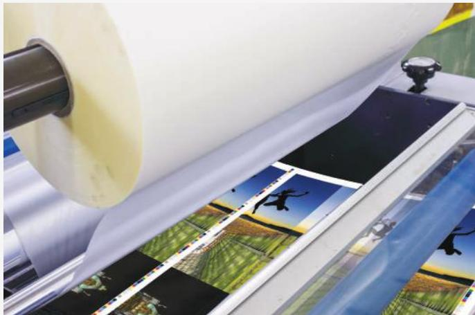
Laminasyon, iki veya daha fazla katlı film oluşturarak istenilen özelliklerde malzeme üretiminin yapılabildiği işleme denir. Bu işlem ambalajın kullanıldığı malzemeye mürekkebin geçmesini, ürünün daha çok parlak olmasını ve mukavemetinin artmasını sağlamaktadır.
