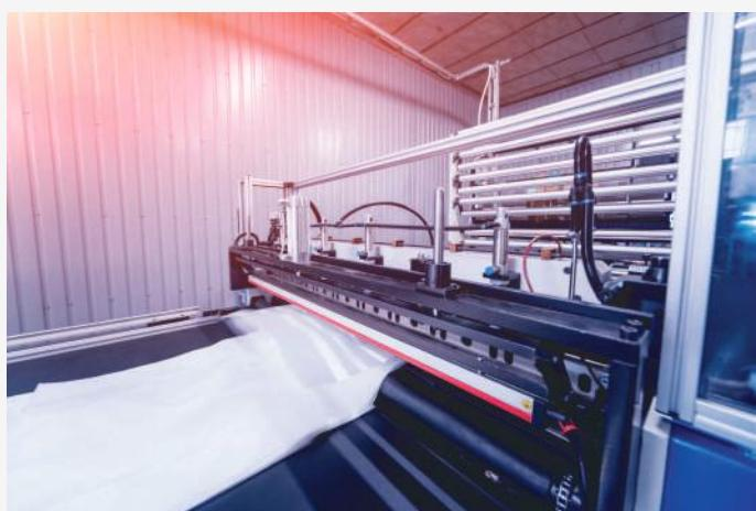
Extrusion, baskı ve laminasyon aşamaları tamamlanan filmler kesim aşamasında istenilen son şekli alır ve sevkiyata hazır hale getirilir.
