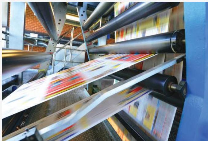
Firmamızda Flexo Baskı sistemi ile 1400 mm genişliğe kadar olan Polietilen, Polipropilen, CPP, OPP, Metalize vb. filmlere baskı yapılmaktadır.
